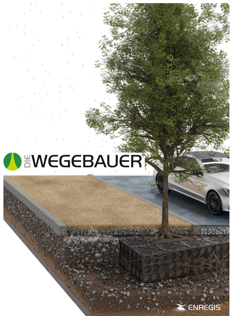
Aufbau einer Wassergebundene Wegedecke mit Sabalith® und Sabadyn® in Kombination mit dem ENREGIS/Treebox® System und Herbavital® Pflanzsubstrat im Schnitt.
