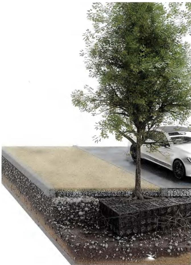
**Bild 2.** Aufbau einer Wassergebundene Wegedecke mit Sabalith® und Sabadyn® in Kombination mit dem ENREGIS/Treebox® System im Schnitt.
